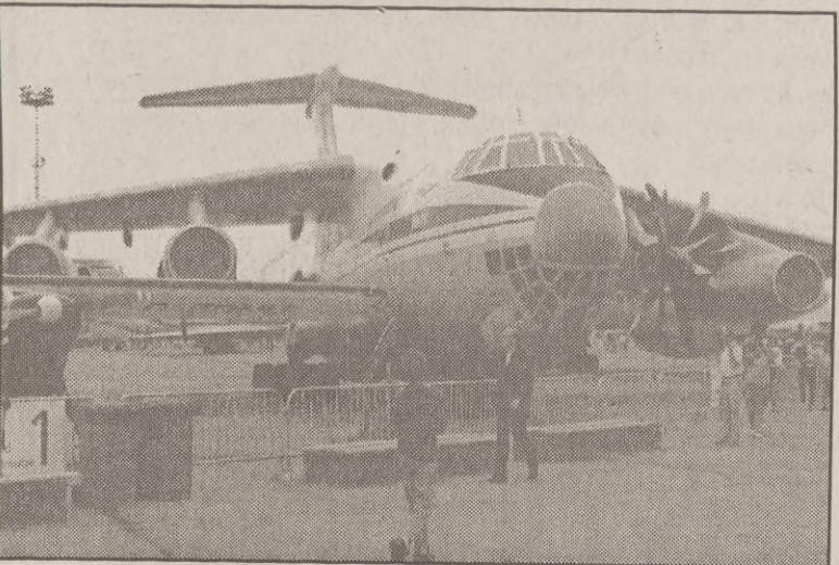
Ten gigantyczny transportowy Il juszyn-76 jest zaopatrzony w silniki Rolls-Royce'a. Jeden z nich posiada śmigła do testowania maszyn. Ten samolot tylko w przedniej części kadłuba ma miejsca dla trzydziestu pasażerów, a w pozostałej dla stu czterdziestu skoczków desantu spadochronowego, którzy wyskakują przez wrota w tylnej części kadłuba. W pełni załadowany ma zasięg 5000 kilometrów. Ulepszona wersja, z dodatkowymi zbiornikami paliwa, zwiększa tę odległość o kolejne 1700 kilometrów. Il-76 załadowany sprzętem wojskowym o wadze od dwudziestu do siedemdziesięciu ton, pobił 26 rekordów świata w prędkości i wysokości przelotu.
