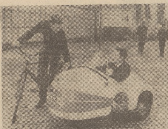
Trzykołowa „Mopetta” (na licencji Brensch) zrobiona z masy plastycznej, wyposażona w silnik 49 ccm o mocy 2,3 HP.
