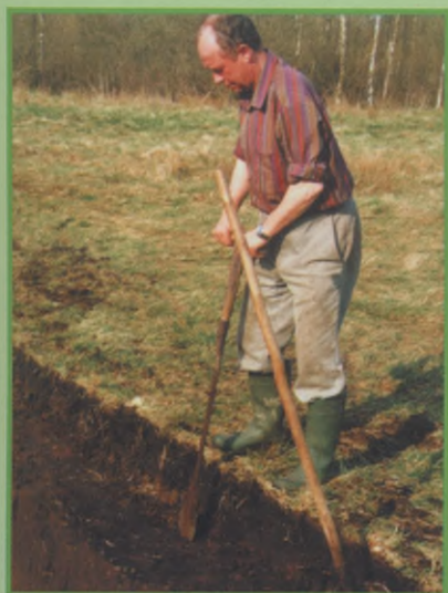
Józef Labuda specjalnym nożem odcina warstwę torfu - na cegły
