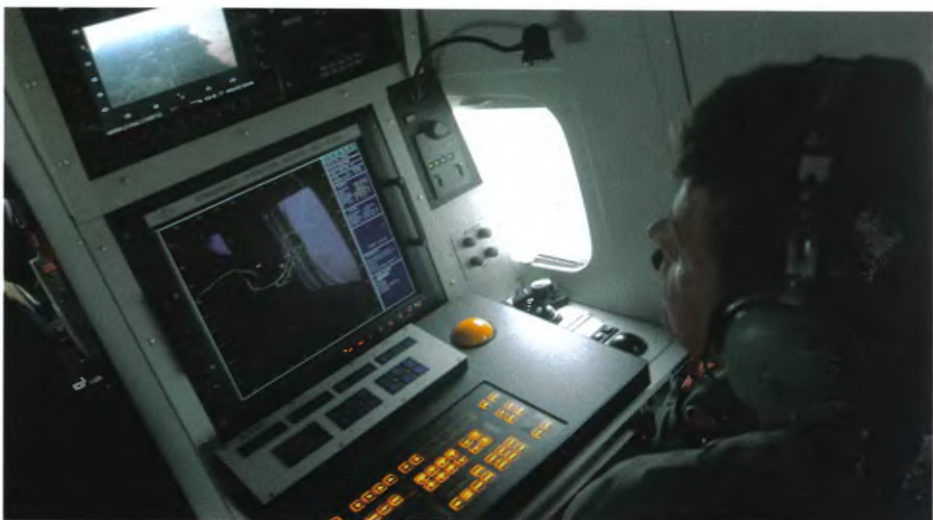
Dariusz Panek ma przed sobą radar i ekran, na którym widzi obraz przekazywany z kamery podwieszanej pod samolotem.
