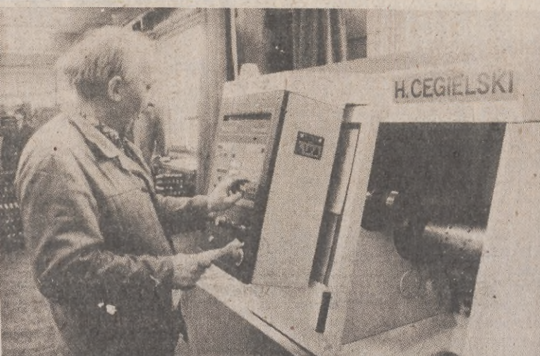
Koszalińskie Zakłady Naprawy Samochodów unowocześniają park maszynowy. Na wydziale produkcji urządzeń zamontowano maszyny wykorzystujące wysokociśnieniową hydraulikę. (kar) Na zdjęciu: elektronik Piotr Ziółkowski uruchamia automat tokarski ATF-45 N, współpracujący z komputerem.
