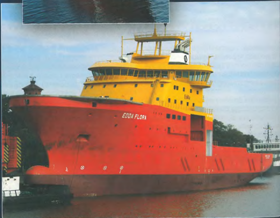
Edda Flora w Świnoujściu. W kadłubie widać puste jeszcze hangary, w którym „garażować” będą zdalnie sterowane pojazdy podwodne.
