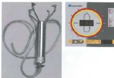
Fot. 1.1. Czujnik siły i kierunku wiatru używany w systemach DP. Źródło 2.
