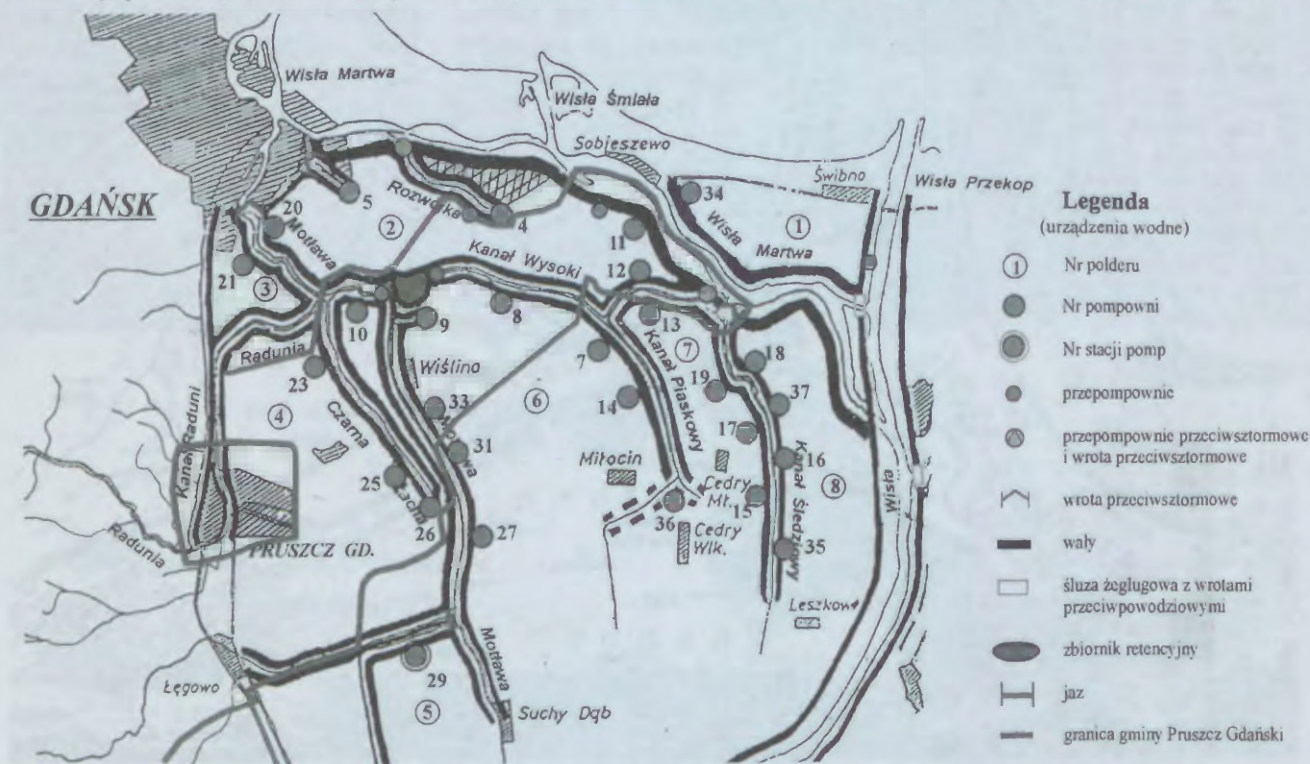
Polderowy system wodno-melioracyjny Żuław Gdańskich (polderowa infrastruktura hydrotechniczna)
