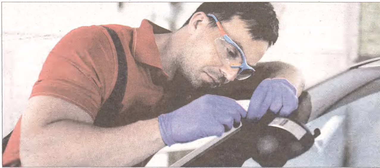
Szybę można naprawiać, jeśli średnica uszkodzenia nie przekracza 24 mm.
