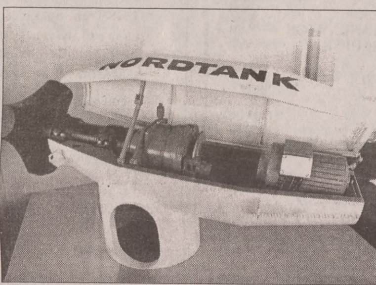
Przekrój gondoli turbiny — wiatrowego agregatu prądotwórczego
