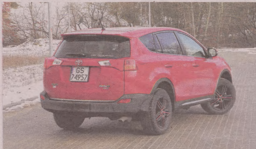
► Z tyłu, w stosunku do poprzedniego modelu, nastąpiła zmiana wręcz rewolucyjna - pokrywa bagażnika otwiera się do góry, a nie jak wcześniej - na bok
