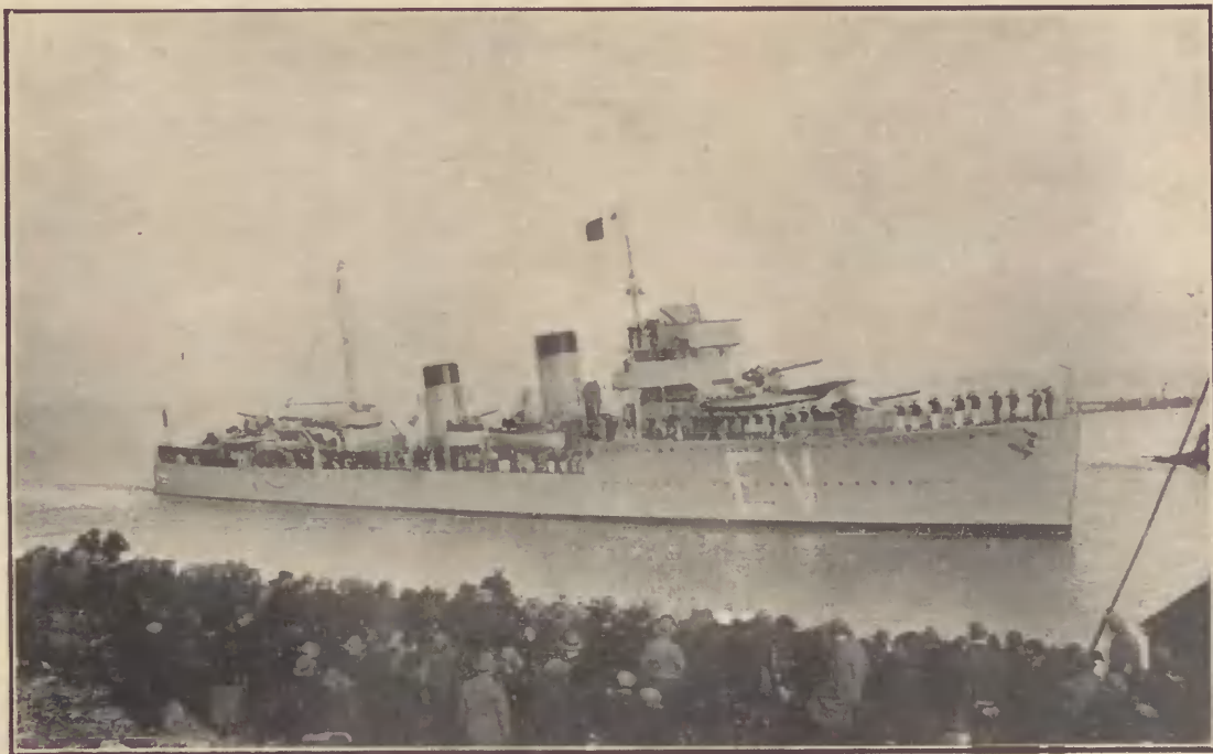
Holenderski kontrtorpedowiec „Evertsen“ wchodzi do portu w Gdyni dnia 27. VI. 1934 r. (Zbudowany w 1926 r., pojemność 1 640 ton, szybkość 36 węzłów, IV — 120 mm, II — 75 mm pl., 4 — K M., 2 potrójne aparaty torpedowe 530 mm, długość 98,1 m., szerokość 9,5 m, zanurzenie 3,2 m, 1 wodnopłatowiec).
