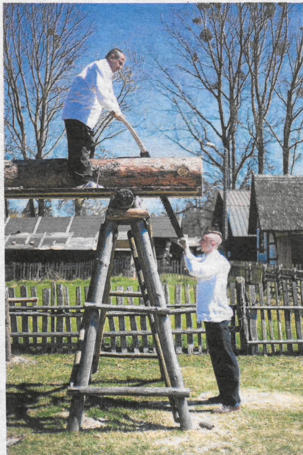
► Ręczną piłą traczną przecierano drewno do budowy domów
