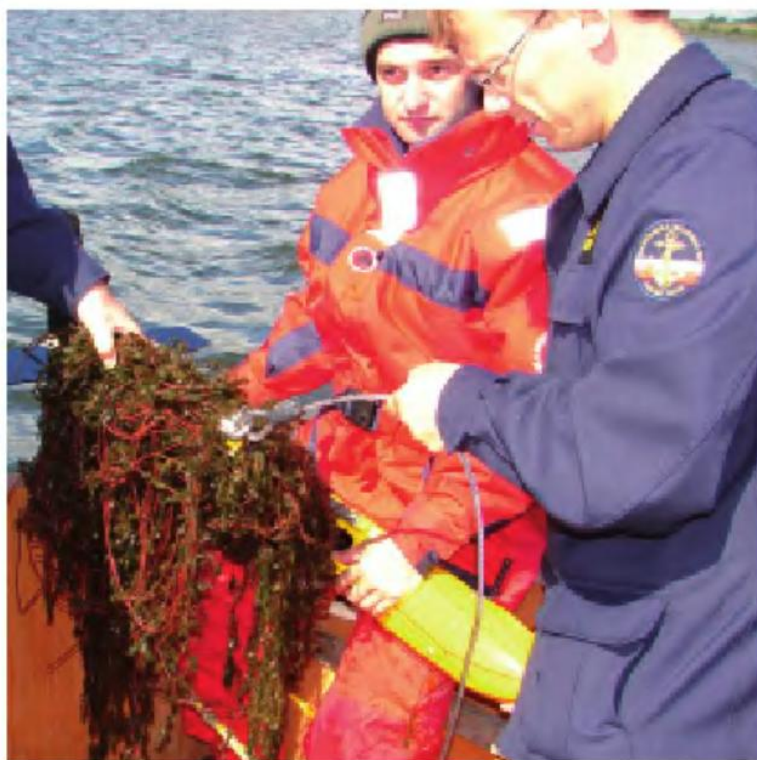
Fot. 2. Czyszczenie sonaru z wodorostów podczas pomiarów na jeziorze Łabap
