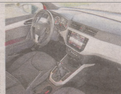
Deska rozdzielcza jest zbudowana głównie z plastikowych elementów
