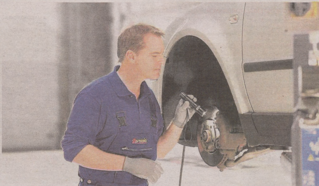
Jednym z częstych powodów wystąpienia tzw. „twardego” pedału hamulca może być stary lub niskiej jakości płyn hamulcowy
