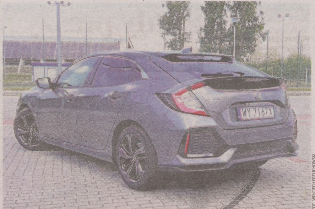
Z tyłu charakterystycznymi elementami są dwa spoilery - jeden nad tylną szybą, drugi na krawędzi pokrywki bagażnika
