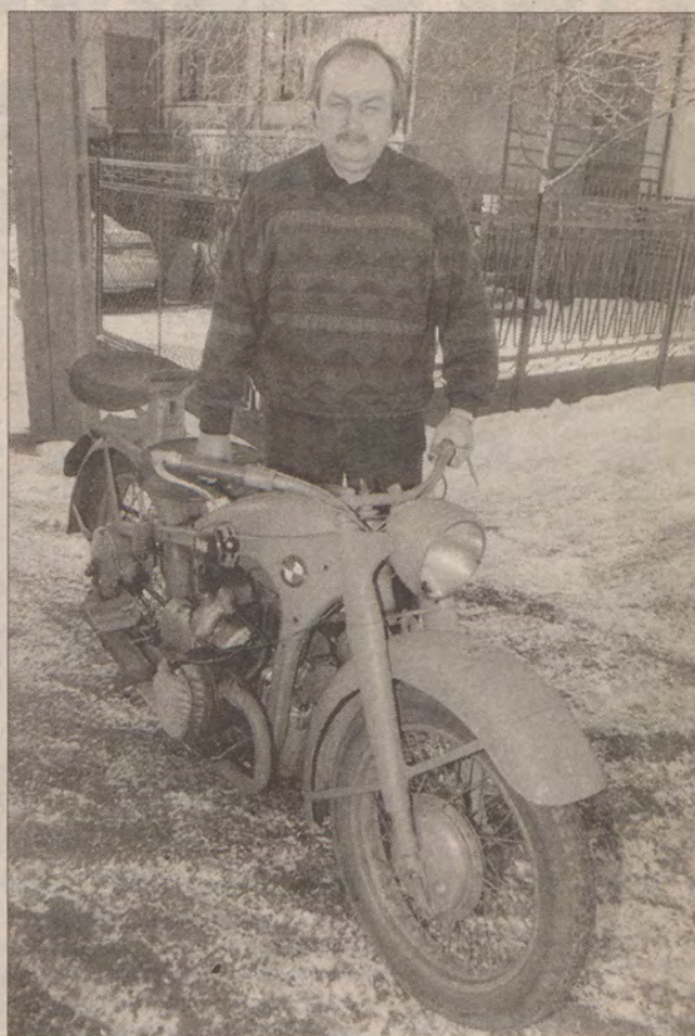
Witold Ciązkowski prezentuje BMW 750 z dwucylindrowym, dolnozaworowym silnikiem typu boxer.
