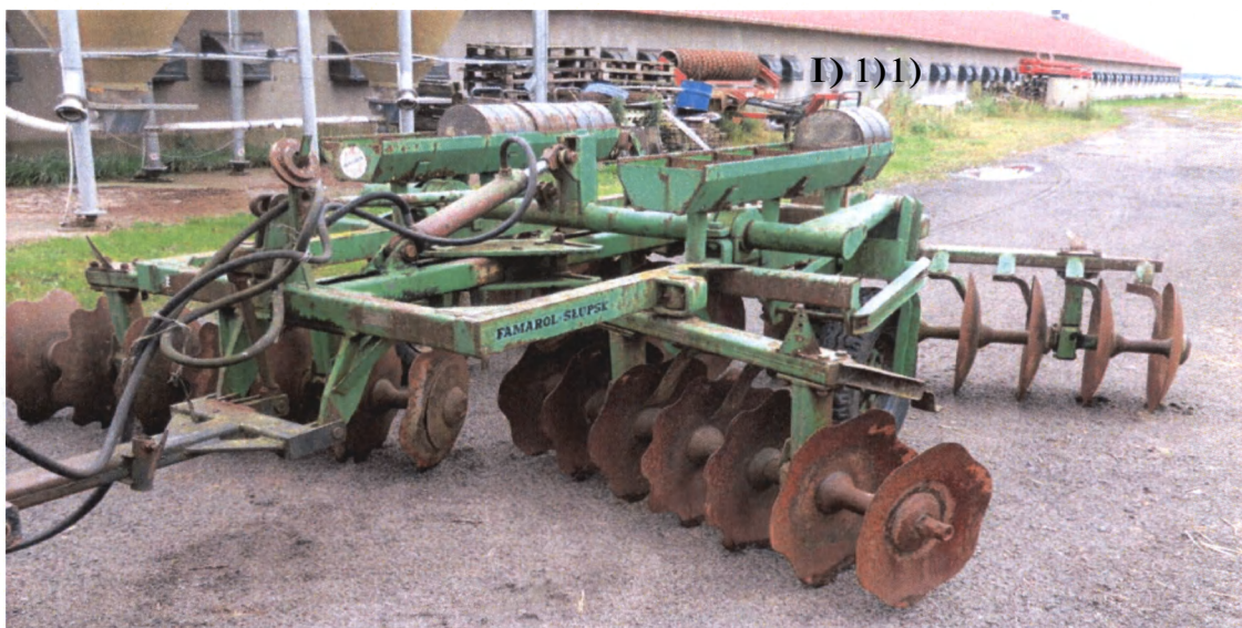
Foto 21 Brona talerzowa hydrauliczna U-242 ciągniona o szerokości roboczej 4m
