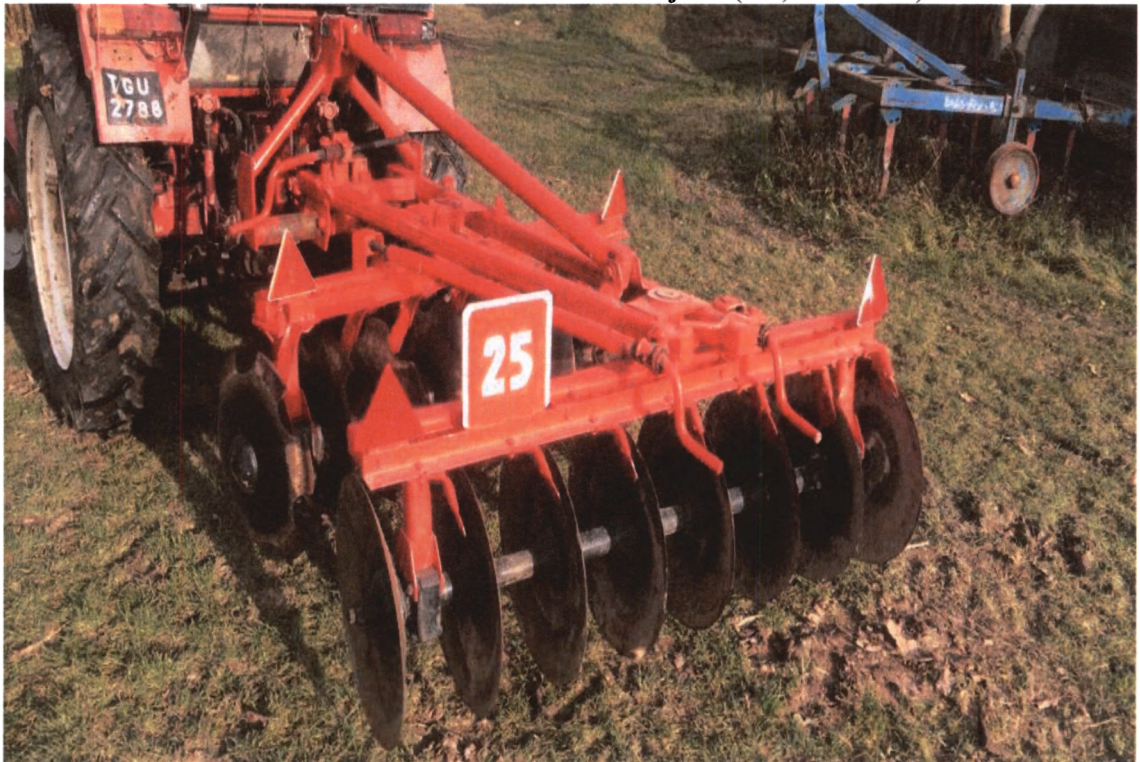
Foto 23 Brona talerzowa zawieszana Z-2 o szerokości roboczej 2 m (Z-2,5 m i Z-3 m)
