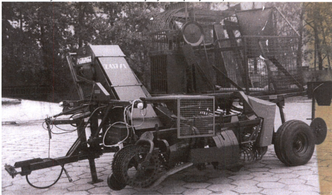
Foto 28 Kombajn do zbioru buraków cukrowych jednorzędowy Z-417/1
