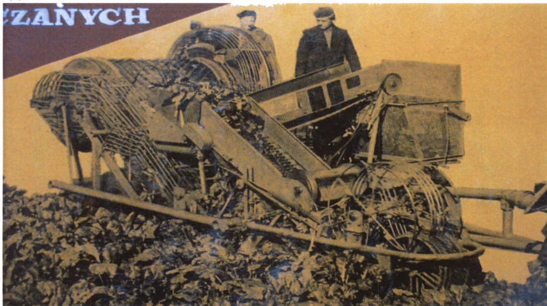
Foto 20 Kombajn jednorzędowy do zbioru buraków cukrowych KBC-1 „Rosomak”, lata produkcji 1963-1967
