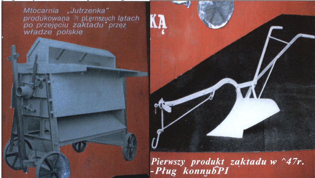
Foto 10 Pierwsze maszyny produkowane w zakładzie w 1947 r. młocarnia szerokomłotowa „Jutrzenka” i pług konny SP-1 konstrukcji Yentzkiego
