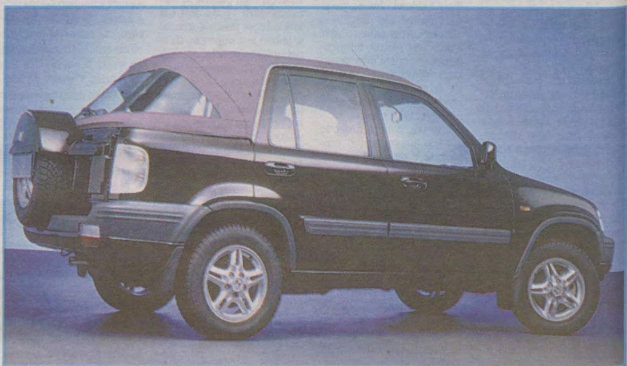
Najnowsze opracowanie centrum rozwojowego Valmet Automotive: automatycznie składany i rozkładany dach dla samochodu rekreacyjnego. Tu - w Hondzie CR-V.
