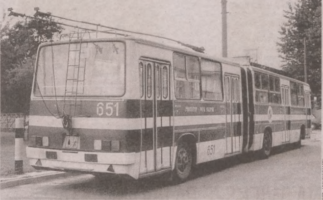
Przegubowy trolejbus zbudowany na bazie autobusu Ikarus przez WPK i Kapenę. Koniec lat 80.
