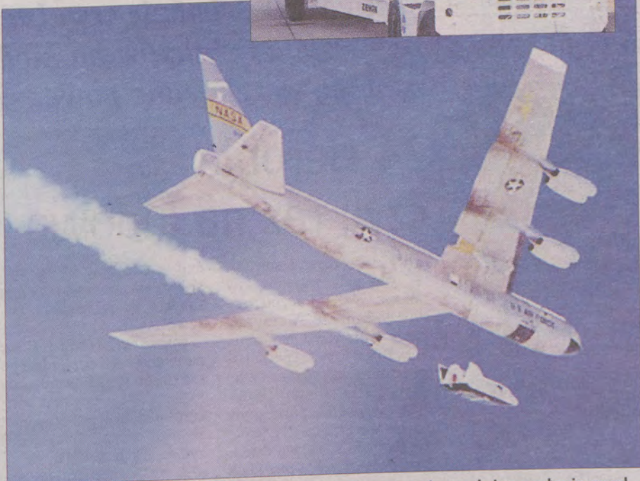
Podczas bieżących testów moduł doświadczalny startuje na dużym pułapie spod skrzydła B-52. Na zdjęciu u góry montaż modułu X-38, przed startem B-52.
