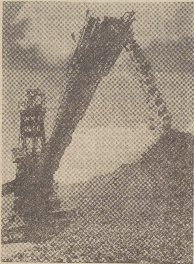
Każdego dnia z odkrywki Turów I i Turów II olbrzymie, ciężkie koparki kroczące, taśmociągi i zwalowiarki wydobywają setki ton węgla brunatnego. Jego najbliższa droga wiedzie do elektrowni Turów. Turoszowskie brunatne skarby wysyłane są wagonami również do NRD. CAF — Wołoszczuk
