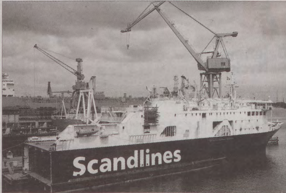
Duński prom pasażersko-samochodowy „Ask”, którego kadłub jest przedłużany w Gdańskiej Stoczni Remontowej o ponad 20 m.
