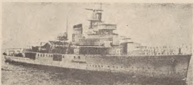
Holenderski okręt szkolny artyleryjski „van Kinsbergen” (rok budowy — 1939; wyporność — 1760 ton; długość — 103 m, szerokość — 11,6 m, zanurzenie — 3,4 m; szybkość — 25 i pół węzła. uzbrojenie: 4 działa 120 mm, 2 działka plotn. 40 mm 6 działek plotn. 20 mm).
