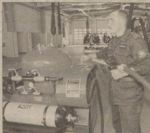
Proszek gaśniczy jest wyrzucany z „pyszcza” węża pod ciśnieniem 16 atmosfer. Aspi-rant szt. Jerzy Banach nie miał jeszcze okazji obejrzenia nowego sprzętu w akcji.
