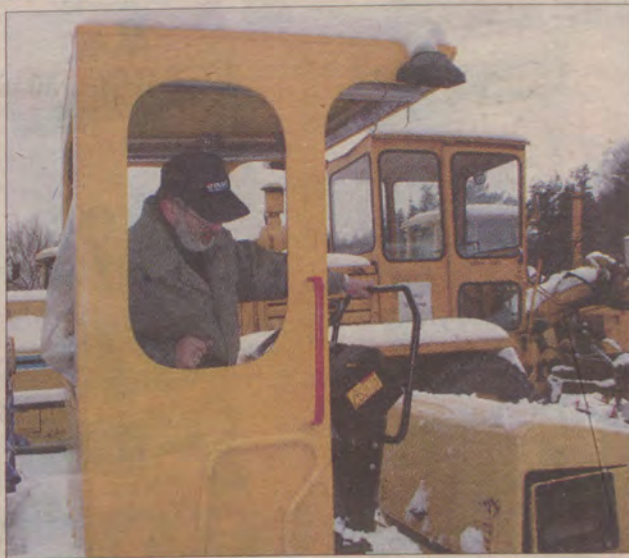
Równiarka pali zaledwie 8 litrów oleju napędowego na 100 km.
