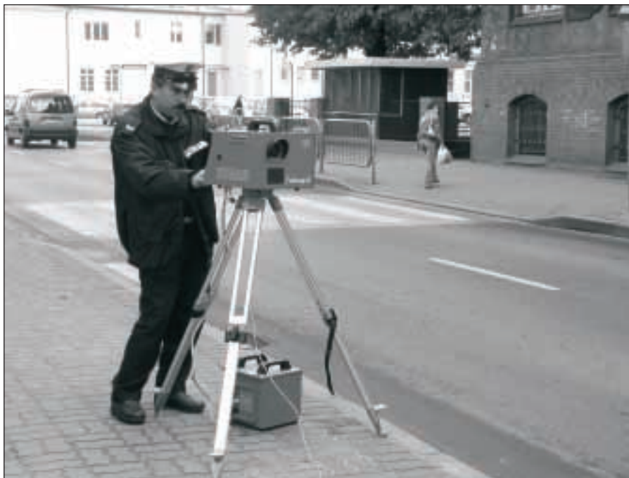
Fotoradar wykorzystywany jest szczególnie do pomiaru prędkości na jezdniach w pobliżu szkół
