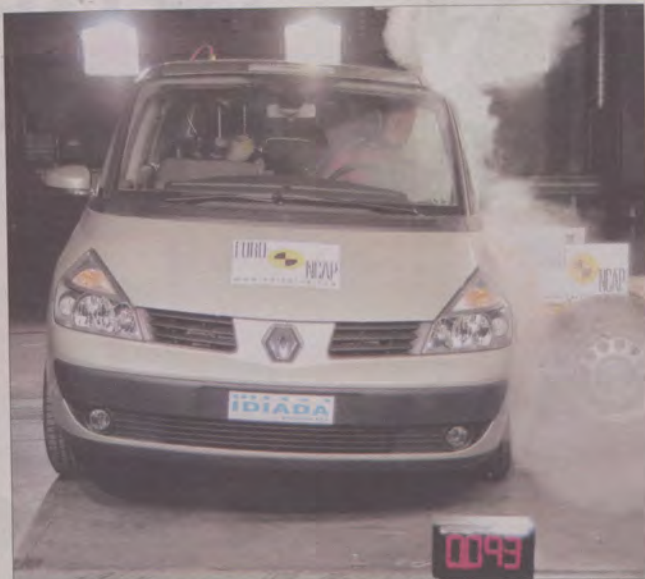
Test zderzenia boczego w drzwi kierowcy stojącego nieruchomo samochodu najeżdża z prędkością 50 km/h odkształcalny wózek z przymocowanym odkształcalnym blokiem aluminium o grubości 50 cm i szerokości 150 cm. Na miejscu kierowcy znajduje się manekin, a na tylnej kanapie - dwa manekiny wielkości dzieci. Ta próba symuluje uderzenie w bok pojazdu.
