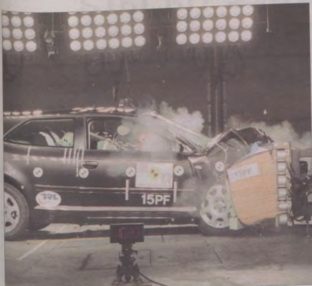
Test zderzenia czołowego polega na najechaniu samochodu z prędkością 64 km/h na odkształcalną przeszkodę przesuniętą nieco w bok od osi symetrii nadwozia. Odkształcalność przeszkody zapewnia blok aluminium (o przekroju plastra miodu) o szerokości 100 cm i grubości 54 cm. W aucie umieszcza się 4 manekiny. Ta próba odzwierciedla zderzenie czołowe z drugim pojazdem.
