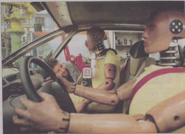
Manekiny do badań odzwierciedlają budowę człowieka i mają zainstalowanych wiele czujników. Koszt manekina wynosi ok. 150 tys. dolarów.
