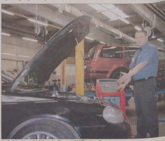
Kazimierz Jaworski dokonuje diagnostyki klimatyzacji.
