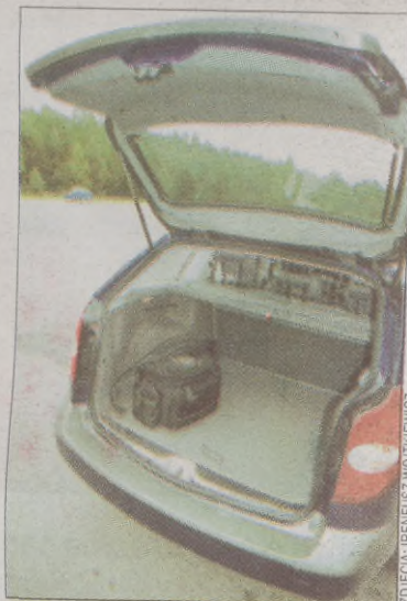
Niespełna 500-litrowy bagażnik można po złożeniu tylnego oparcia powiększyć trzykrotnie
