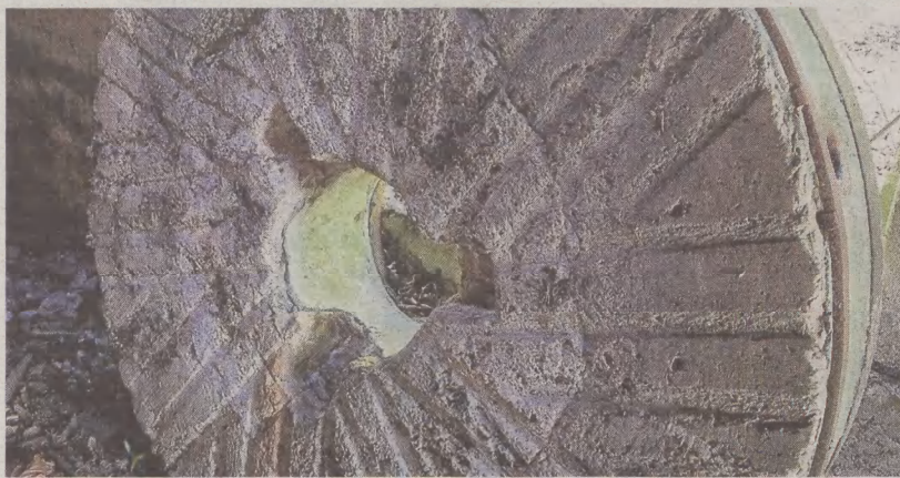
Kamień młyński. W każdym młynie były dwa. Dolne i górne (ruchome z wyżłobieniami)
